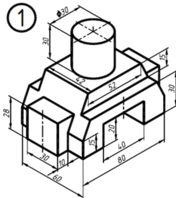
3) Выполните изометрическую проекцию детали по трём видам
